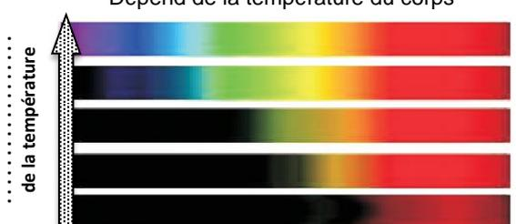
Évolution du spectre d'un solide chauffé à une température de plus en plus élevée
